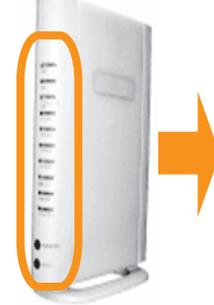
※正常動作時は、電源、インターネット回線、電話の各ランプが緑色に点灯します。
